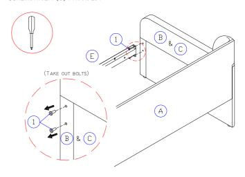
STEP 3 - ATTACHING TRUNDLE FRONT PANEL TO TRUNDLE CROSS RAIL
