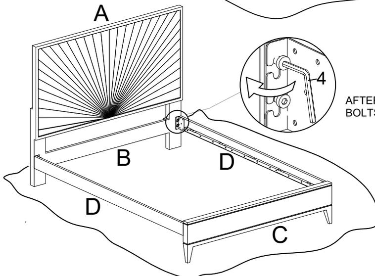
AFTER SIDERAIL SET IN POSITION TIGHTEN THE BOLTS COMPLETELY.
