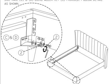
MAKE SURE THE BOTTOM LEG SURFACE FLUSH TO THE FLOOR LEVEL. THEN FULLY TIGHTEN THE BOLTS. FOLLOW DETAIL AS SHOWN.
