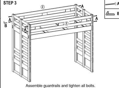
MAKE SURE ALL BOLTS ARE TIGHTENED COMPLETELY
