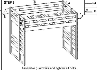
MAKE SURE ALL BOLTS ARE TIGHTENED COMPLETELY
